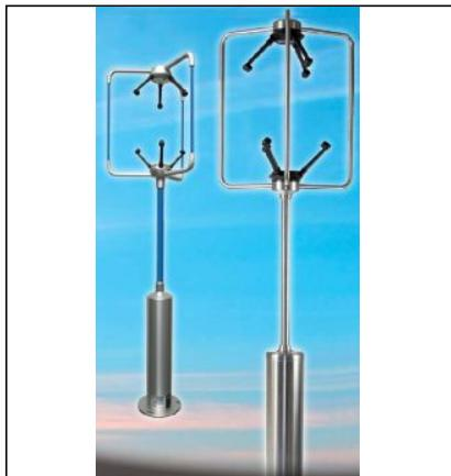
**WindMaster II**シリーズは橋梁、ビルディング、風力発電風車、ベンチレーションコントロールシステム、気象、フラックス研究などにおいての乱流計測に最適です。U,V,Wによるベクトルのデジタル出力にも対応しており、音速と音仮温度の出力も可能です。**WindMaster II**はアルミニウムとカーボンファイバー製で、サンプリングレートが20Hz(標準)と32Hz(オプション)から選択可能です。アナログの入・出力は12ビット・14ビットのいずれかより選択可能です。
