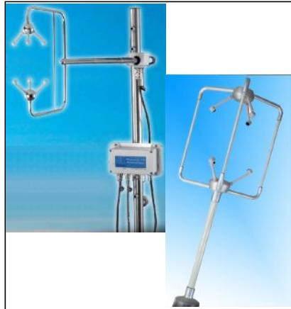
**Research**シリーズ(**R3&HS**)は渦共分散によるフラックスの研究に最適です。本シリーズはU,V,Wと音速(音仮温度)の出力が可能で、ギル社フリーソフトの**WindCom**により、データの記録が可能です。測器の電源とアナログ出力は付属品の**PCIA**(電源・アナログ通信装置)によって供給可能です。アナログ入力は**HS**タイプには標準で付属し、**R3**タイプの場合はオプションのセンサーインプットユニット(**SIU**)を介して対応可能です。
